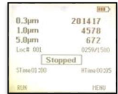
Display från instrument som räknar större partiklar i tre storleksklasser
