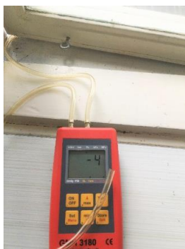
Tryckmätning via fönsterspringa (hemma hos mig)
