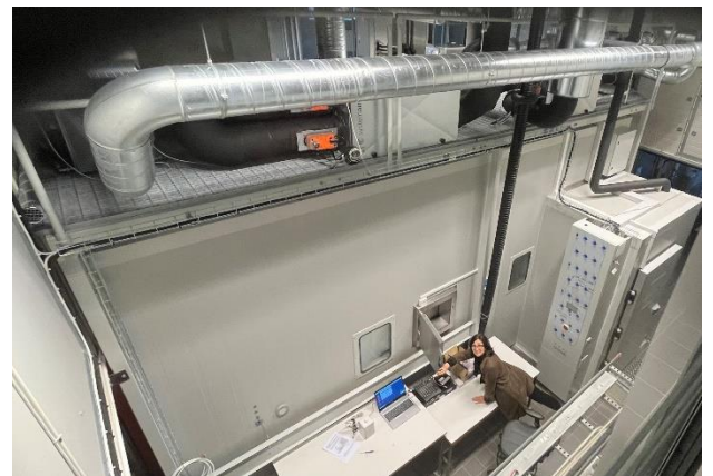
Den nya exponeringskammaren snett uppifrån. Aneta Wierzbicka öppnar en lucka där försöksdeltagare kan lämna prover mm utan att kammardörren behöver öppnas. Th en av ingångsdörrarna.
